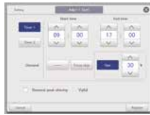
Bildschirmanzeige für Leistungsbegrenzung (Lastabwurf) des Aussengeräts.
