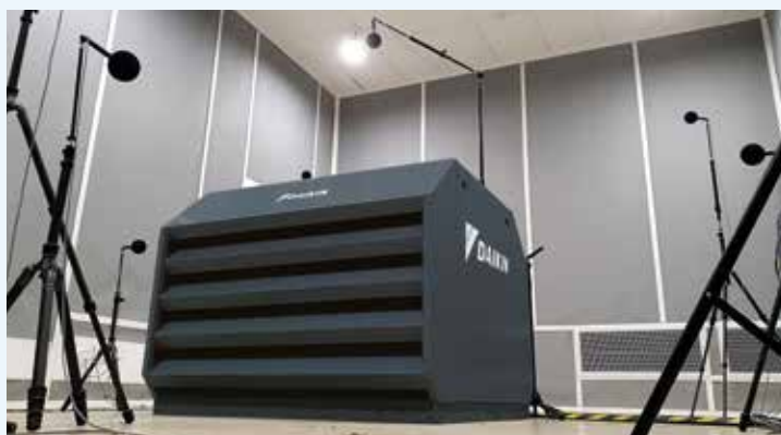
Messung der Schallleistungspegel in einer Akustikkammer
